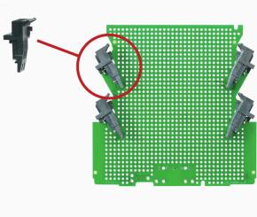
焊接插座，焊针长度最适合波峰焊工艺。提供标记和编码空间。
