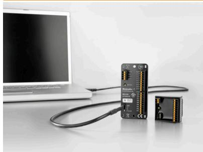
通过全封闭的WCU 501和WCU 650逻辑模块，即使在最极端的环境条件下，您也可监视、控制并调整您的进程。由此，WCU系列可提供最优化的尺寸、性能、稳定性和用户易用性。图形化和直观的Micon-L编程环境可实现模拟和数字输入的灵活切换，以及数字输出。软件和硬件范围均可根据客户的具体需求相应扩展。
