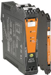
提供电源转接器模块，用于为 ACT20 系列/MICROSERIES 信号转换器单独供电和配电。将 22.5/ 6.1 mm 宽的馈电模块直接安装在模拟信号转换器的附近。可以通过 CH20M (ACT20 系列) 导轨总线桥接 24 VDC 电源，也可以使用 ZQV 4N (MICROSERIES) 横联件简单桥接。ACT20-Feed-In-PRO-S 也可以检测到 CH20 总线上任何设备的故障。如果发生错误或故障，内置状态继电器向外部控制器发送警报。此外，还可以将两个电源装置（一个主电源，一个备用电源）连接至 ACT20-Feed-In-PRO-S。安装在 CH20 总线上的两个馈电模块保证一个 100% 冗余电源。采用三盏 LED 显示电源状态和错误信息。ACT20M-Feed-In PRO 还可用于防爆区 2/ 区 2。
