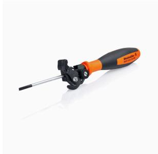
Swifty® CS 和 Swifty® CS set 集成断线剥线功能, 用于切割和剥离铜导线, 适用于最大 1.5 mm<sup>2</sup> 的单股硬导线和 2.5 mm<sup>2</sup> 的多股软导线。
