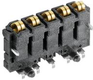
模块化电子外壳系统的集成式导轨总线在模块应用的供电、连接和分配中，导轨总线用无中断的灵活的系统解决方案取代了成本过高的单线束。系统总线牢固地集成在 35 mm 标准安装轨内。SMD 总线接触块可进行回流焊，因此可以在组件装配期间完全自动处理。耐用的镀金接触表面确保在所有外壳宽度下都能实现永久可靠接触。
