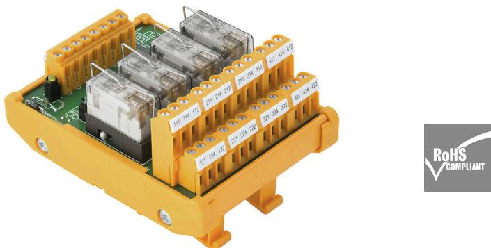
继电器底座 (RSM) 具有通用正负极, 可接至PLC或其他类型的控制器。接口由 4、8 或 16 个 RCL (12.7 mm) 或 RSS (6.1 mm) 继电器组构成。可用拔插式连接器或采用 IEC 60603-13 连接器进行控制器接线。多种选择:
