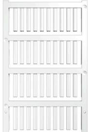
SlimFix 是带有节约空间的思想设计出来的导线和电缆标记号。可以在导线安装完成后再安装标记号。标记号由无卤素的材料制成，并且满足阻燃等级 V0/V2 的要求。SlimFix 在交通轨道行业中得到广泛认可和应用。SF 工具可以使非常小的导线也很容易安装。
