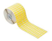
THM GEW 纺织标签由柔性极高的棉织品制成。 以卷装形 式供货,适合与热传输打印机一起使用。与办公室激光打 印机的 A4 纸标签相比,这种标签带有更厚的粘胶层。 织物柔性和厚粘胶层相互结合,确保高粘力,可用于电缆 或软管等弯曲或圆形物体。
