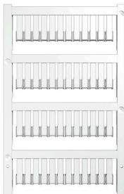
ZS 标记号 —— 采用久经验证的 MultiCard 格式，专为 Z 系列端子开发。它提供宽敞的打印面积。可翻转式机械结构允许在标记号位置进行横联而不需要拆除标记号。单排标记号可以进行成条安装，快速便捷。单个标记号之间很容易分开。
