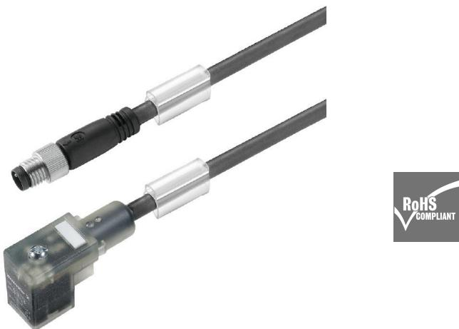
魏德米勒可以提供阀塞作为连接线，其中带有 M8/M12 插头，且单侧开放。阀塞的状态用一个 LED 显示。每个阀塞都有一个保护电路。魏德米勒系列包括符合 DIN 和工业标准的 A、B 和 C 型阀塞。阀塞拧紧后可达到 IP 67 防护等级。出口方向也是一个决定性因素，因此魏德米勒提供不同出口方向的版本。
