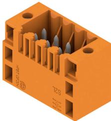
直型双排插座，有闭口或法兰版本（如有要求可提供一侧开放的版本）。插座的插针长为3.5 mm，适用于波峰焊，盒装。可以螺钉固定于印刷电路板（PCB）。组件上有空间供标记和编码使用。
