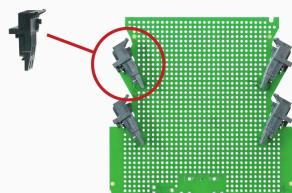
耐高温, 直型开口款插座。用纸盒或卷带包装。卷装插座采用 1.5mm 焊针, 适合自动装配。3.2mm 长的焊针适合采用回流焊和波峰焊进行处理。针式插座上有空间进行标记和编码。HC = 大电流
