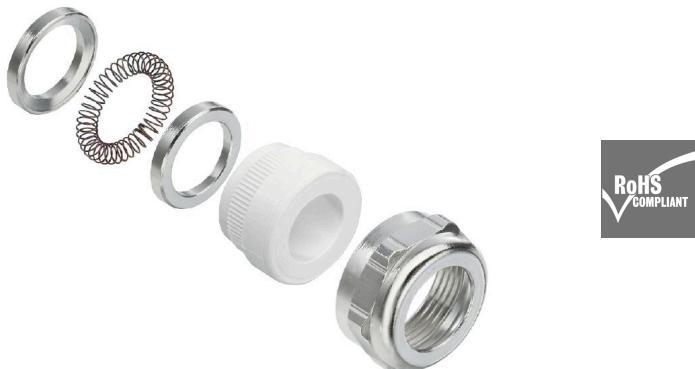
随着电子组件的灵敏度不断提高，电磁干扰频率不断提高，电缆接头需要在系统的屏蔽概念中发挥重要作用。这类EMC电缆接头采用360°筛查接线点，可屏蔽干扰频率。手指锁定密封件可提供出色的电缆保持和张力释放效果，其旁边的电缆接头符合EN 62444的机械要求。专利设计让组装变得轻松快捷。
