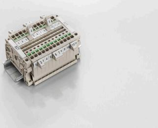
标识牌支架允许以 5 或 5.1 mm 的节距额外安装标准标识牌。倾斜支架可以选择性地卡扣在一起，并可以安装在 Klippon® Connect 模块化端子排的所有标准标记通道中。匹配的标识牌类型可以在指派标记支架的相应附件下方找到。
