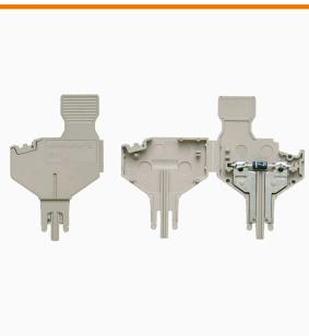
插头组件用于将电气组件安装在可拆式接线端子。电子组件完成焊接之后, 可以将插头安装到可拆式接线端子的断开区域, 从而将可拆式接线端子变成配有内置电子组件的模块化接线端子。
