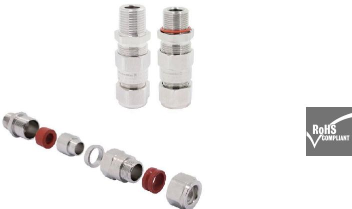
E1W 型电缆接头适合 SWA 钢丝铠装电缆，具有防火 Ex d 和增安型 Ex e 防爆性能。铠装线夹在电缆铠装和格兰头之间实现电气接合。
