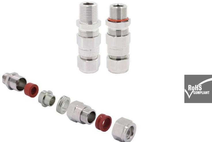
E1XZ 型电缆接头适合 SWB 编织钢丝或 STA 铜带铠装电缆，具有防火 Ex d 和增安型 Ex e 防爆性能。铠装线夹在电缆铠装和格兰头之间实现电气接合。
