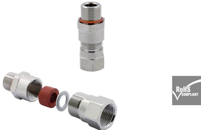
A2LC 型电缆接头适合非铠装电缆，提供导管连接内螺纹，具有防火 Ex d 和增安型 Ex e 防爆性能。
