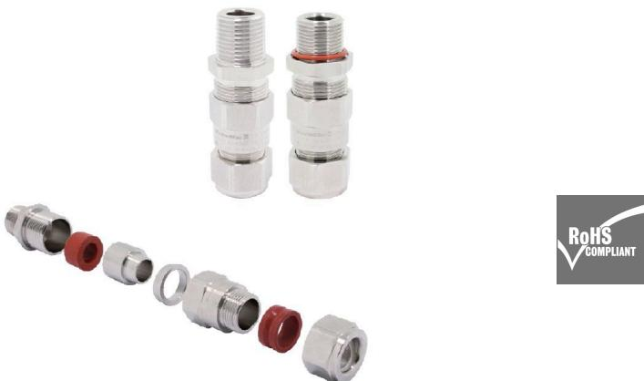
E1W 型电缆接头适合 SWA 钢丝铠装电缆，具有防火 Ex d 和增安型 Ex e 防爆性能。铠装线夹在电缆铠装和格兰头之间实现电气接合。
