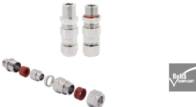
E1W 型电缆接头适合 SWA 钢丝铠装电缆，具有防火 Ex d 和增安型 Ex e 防爆性能。铠装线夹在电缆铠装和格兰头之间实现电气接合。
