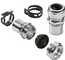
随着电子组件的灵敏度不断提高，电磁干扰频率不断提高，电缆接头需要在系统的屏蔽概念中发挥重要作用。这类EMC电缆接头采用360°筛查接线点，可屏蔽干扰频率。手指锁定密封件可提供出色的电缆保持和张力释放效果，其旁边的电缆接头符合EN 62444的机械要求。专利设计让组装变得轻松快捷。
