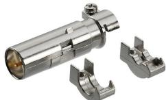
ConCept - CSB - 模块采用双模块设计，在 ConCept 模块框架中占有两个槽。ConCept - CSB - 模块由一个模块架组成，该支架能够容纳两个插针架。插针架由锌压铸合金制成，保证了出色的屏蔽特性。冷压插针与插针架绝缘，安装在塑料插芯中。提供一系列 1 回路、4 回路、8 回路等不同回路数，以满足各种应用。
