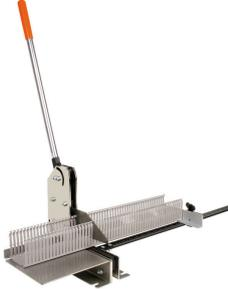
导线槽切割器，适用于在切割导线槽和盖板内进行人工工作，最大宽度为 125 mm，壁厚为 2.5 mm。仅适用于未经填料加固的塑料。
