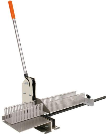
导线槽切割器，适用于在切割导线槽和盖板内进行人工作业，最大宽度为 125 mm，壁厚为 2.5 mm。仅适用于未经填料加固的塑料。
