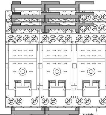
横联件桥接至相邻底座上相同的接线点
