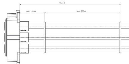
为避免损坏触点和绝缘套管，我们建议将电缆固定。对应的距离如下图所示。电缆固定件不包括在交付范围内。
