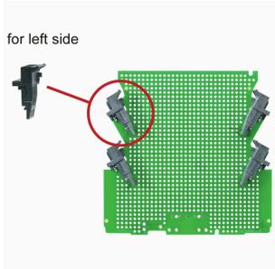
焊接插座，焊针长度最适合波峰焊工艺。提供标记和编码空间。
