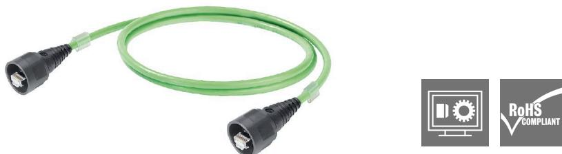
应用于EtherNet/IP 应用的预装配 IE 电缆，带符合 IEC 61076-3-106 var. 1, cat. 5 的卡口接头，配有护套
