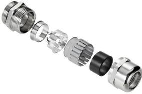
随着电子组件的灵敏度不断提高，电磁干扰频率不断提高，电缆接头需要在系统的屏蔽概念中发挥重要作用。这类EMC电缆接头采用360°筛查接线点，可屏蔽干扰频率。手指锁定密封件可提供出色的电缆保持和张力的释放效果，其旁边的电缆接头符合EN 62444的机械要求。专利设计让组装变得轻松快捷。
