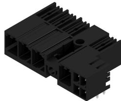
直插式接线组合式插座，间距为 7.62，进线方向为 90°，带电源和信号触点，还包括自动锁定的中央法兰和（可选的）插拔式屏蔽联接。
