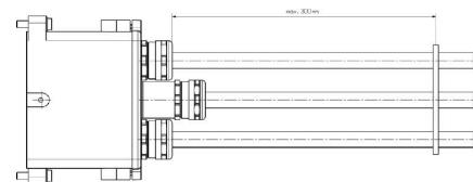
为避免损坏触点和绝缘套管，我们建议将电缆固定。对应的距离如下图所示。电缆固定件不包括在交付范围内。
