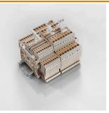
SnapMark —— 这种标记座最早是专门为 I 系列的 IDK 1.5 N 的双层端子构思而研发的。 灵活的可旋转的结构可以毫 不费力地装配和拆卸横联件。 这种标记座可以适合装四个 DEK 5 标记号和两个 WS 10/5 (中间脚)的标记号。
