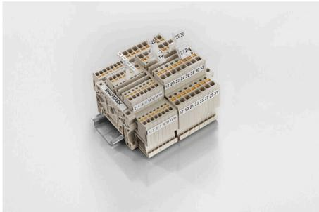
SnapMark — 这种标记座最早是专门为 I 系列的 IDK 1.5 N 的双层端子构思而研发的。灵活的可旋转的结构可以毫不费力地装配和拆卸横联件。这种标记座可以适合装四个 DEK 5 标记号和两个 WS 10/5 (中间脚) 的标记号。
