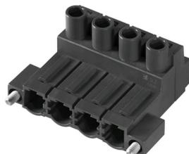
180°反向焊接插座, 采用压线框接线技术, 用于 2.5 mm<sup>2</sup> 现场接线, 7.62 间距。也极适合用作针对反向电压的防触电解解决方案。
