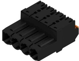
180° 反向焊接插座, 采用直插式接线技术, 用于 2.5 mm<sup>2</sup> 现场接线, 7.62 间距。也极适合用作针对反向电压的防触电解方案。
