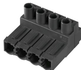
180° 反向焊接插座, 采用压线框接线技术, 用于 2.5 mm<sup>2</sup> 现场接线, 7.62 间距。也极适合用作针对反向电压的防触电解方案。
