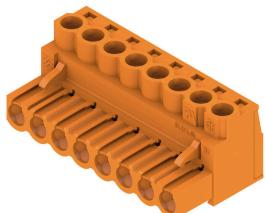
压线框接线插头, 用于直式 (180°) 电线联接。插头上有空间供标记和编码使用。通过法兰或释放杆锁紧。提供十/一字头螺钉和导线误插保护, 供货时压线框打开。HC = 大电流
