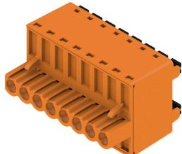
强大的并联解决方案不仅适用于大功率信号总线, 也适用于载流能力高达 18.5A 的 400V 辅助电源 很大的接线范围 (导线横截面积可达 2.5mm<sup>2</sup> ) 确保低电压降, 尤其适用于长总线电缆或高电流传输。
