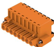
强大的并联解决方案不仅适用于大功率信号总线，也适用于载流能力高达 18.5A 的 400V 辅助电源。很大的接线范围（导线横截面积可达 2.5mm<sup>2</sup>）确保低电压降，尤其适用于长总线电缆或高电流传输。提供 4 种法兰类型，包括受专利保护的释放杆，用于可以根据需要设计联锁机构。
