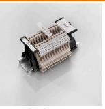
SCHT 5 S 成组记座可以直接卡在 TS32 安装导轨(G 型轨)或 TS35 安装导轨(U 型轨)上。您无需考虑接线端子型号,即可对端子条进行成组标记。
