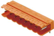
焊接插座，进线方向为 90°。焊针长度最适合波峰焊。提供标记和编码空间。
