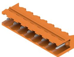
插座由玻璃纤维-增强型聚酯制成, 带90°电缆输出; 适合波峰焊。法兰版本 (F) 的产品可用螺钉安装到相应的背板或电路板上。使用焊接法兰 (LF) 时, 无需在电路板上外加螺钉联接。同时保护焊接点不受机械应力的影响。可以对所有插座进行人工编码或选择订购预编码的插座。HC = 大电流
