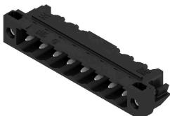
耐高温插座, 采用纸盒包装或卷带包装。卷装插座采用 1.5mm 焊针, 适合自动装配。3.2mm 长的焊针适合采用回流焊和波峰焊进行处理。针式插座上有空间进行标记和编码。HC = 大电流
