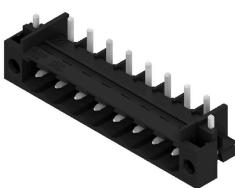
耐高温, 直型开口款插座。用纸盒或卷带包装。卷装插座采用 1.5mm 焊针, 适合自动装配。3.2mm 长的焊针适合采用回流焊和波峰焊进行处理。针式插座上有空间进行标记和编码。HC = 大电流
