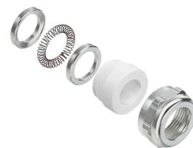
随着电子组件的灵敏度不断提高, 电磁干扰频率不断提高, 电缆接头需要在系统的屏蔽概念中发挥重要作用。这类EMC电缆接头采用360°筛查接线点, 可屏蔽干扰频率。手指锁定密封件可提供出色的电缆保持和张力释放效果, 其旁边的电缆接头符合EN 62444的机械要求。专利设计让组装变得轻松快捷。
