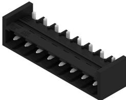
耐高温, 直型开口款插座。用纸盒或卷带包装。卷装插座采用 1.5mm 焊针, 适合自动装配。3.2mm 长的焊针适合采用回流焊和波峰焊进行处理。针式插座上有空间进行标记和编码。HC = 大电流
