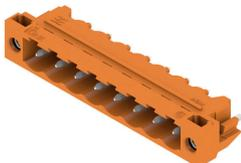
插座由玻璃纤维-增强型聚酯制成, 带90°电缆输出; 适合波峰焊。法兰版本 (F) 的产品可用螺钉安装到相应的背板或电路板上。使用焊接法兰 (LF) 时, 无需在电路板上外加螺钉联接。同时保护焊接点不受机械应力的影响。可以对所有插座进行人工编码或选择订购预编码的插座。HC = 大电流
