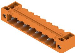
插座由玻璃纤维-增强型聚酯制成, 带90°电缆输出; 适合波峰焊。法兰版本 (F) 的产品可用螺钉安装到相应的背板或电路板上。使用焊接法兰 (LF) 时, 无需在电路板上外加螺钉联接。同时保护焊接点不受机械应力的影响。可以对所有插座进行人工编码或选择订购预编码的插座。HC = 大电流
