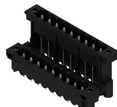
耐高温双层闭合插座, 横向偏置, 可选配焊接法兰。1.5 毫米焊针适合回流焊。3.2 毫米焊针适合回流焊和波峰焊。提供标记和编码空间。
