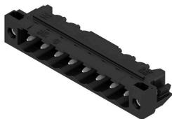
耐高温插座, 采用纸盒包装或卷带包装。卷装插座采用 1.5mm 焊针, 适合自动装配。3.2mm 长的焊针适合采用回流焊和波峰焊进行处理。针式插座上有空间进行标记和编码。HC = 大电流
