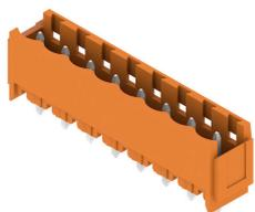
插座由玻璃纤维-增强型聚酯制成, 180度出线; 适合波峰焊。法兰版本 (F) 的产品可用螺钉安装到相应的背板或电路板上。使用焊接法兰 (LF) 时, 无需在电路板上外加螺钉联接。同时保护焊接点不受机械应力的影响。可以对所有插座进行人工编码或选择订购预编码的插座。HC = 大电流
