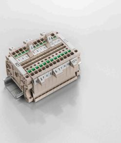
标识牌支架允许以 5 或 5.1 mm 的节距额外安装标准标识牌。倾斜支架可以选择性地卡扣在一起，并可以安装在 Klippon® Connect 模块化端子排的所有标准标记通道中。匹配的标识牌类型可以在指派标记支架的相应附件下方找到。
